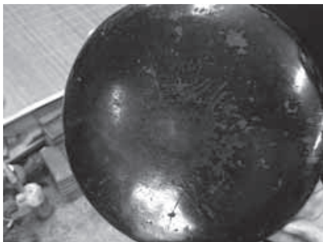
図2 中心部分を頂点として緩やかに丸くなっているため、長く使われた盆の中心は漆塗りが剥がれている。
